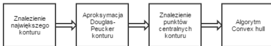
Rys. 12 Etapy wyznaczające parametry przetwarzanego obrazu
