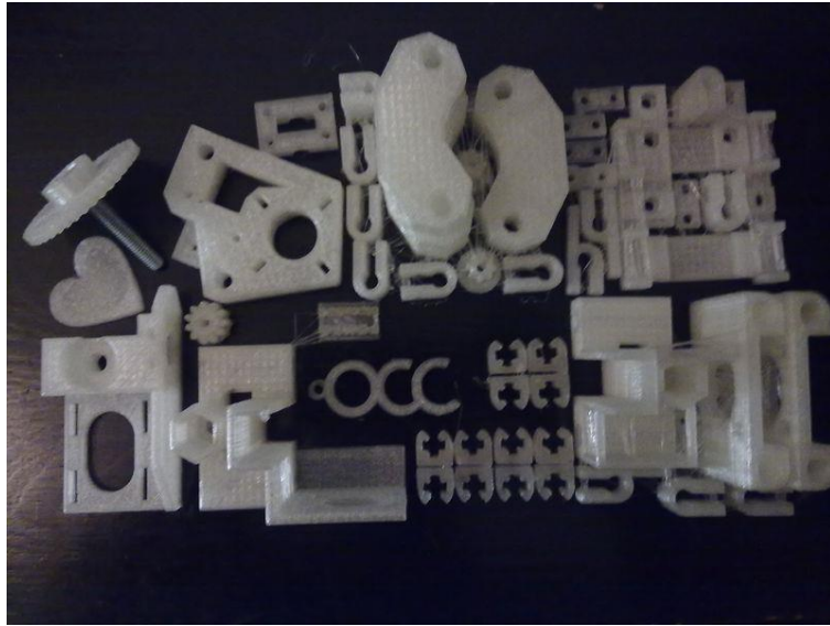
Rysunek 2: Zestaw części do drukarki 3D wydrukowanych na innym urządzeniu tego typu [8].
