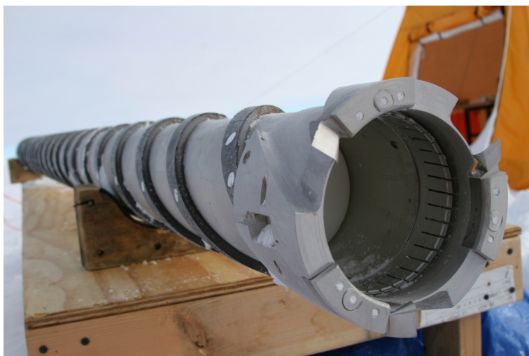
Rysunek 1.7: Mechaniczna głowica wiertła z frezami używanymi do wycinania pierścienia wokół rdzenia lodu. Fot. Steven Profaizer, NSF [29].
