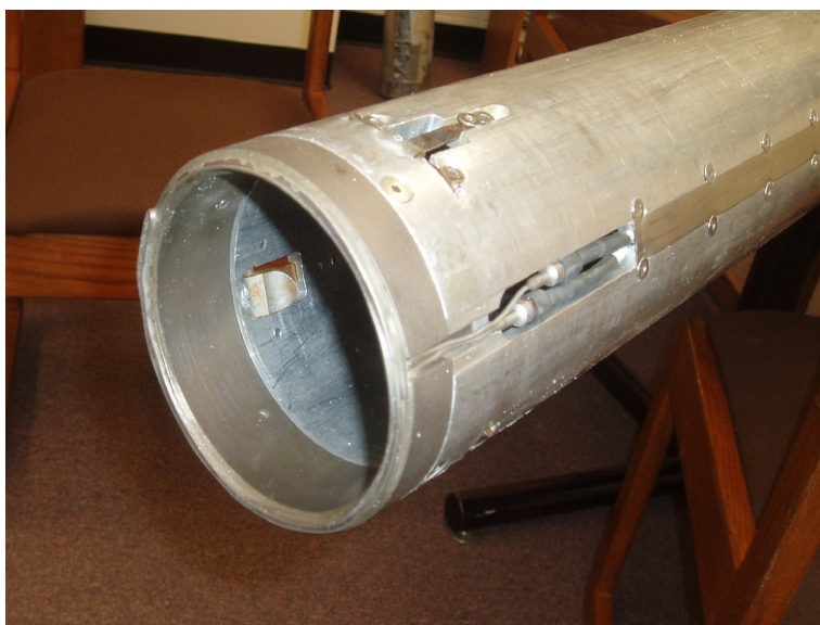
Rysunek 1.8: Głowica wiertła termicznego bez frezów. Wiertła termiczne wykorzystują element grzejny do topienia pierścienia wokół lodu. Fot. Tony Wendricks, Univ. Wisconsin [29].
