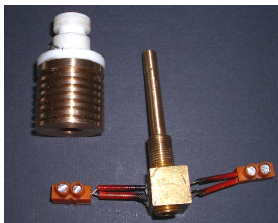
Rys. 36: Dwuczęściowy korpus wraz z mosiężną rurką prowadzącą osadzoną w bloku grzewczym.
