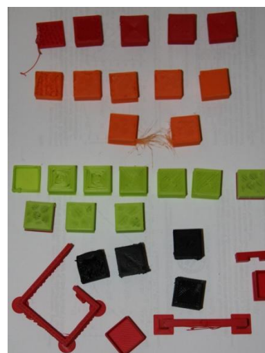
Rys. 11: Część wydruków wykonanych w trakcie kalibracji urządzenia
