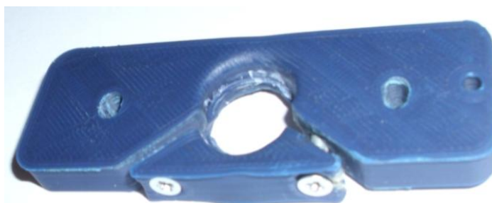
Rys. 46: Przegrzany uchwyt głowicy
