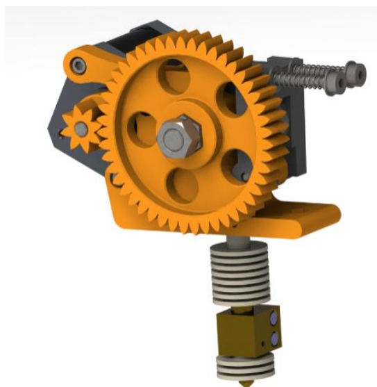
Rys. 18: Model ekstrudera wraz z głowicą 7h7. Model wykonany w SolidWorks 2016.
