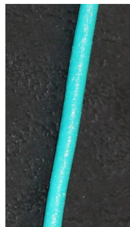
Rys. 16: Fragment żyłki PA6/MMT
