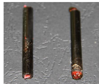
Rys. 35: Zatkane i spęcałe rurki prowadzące.
